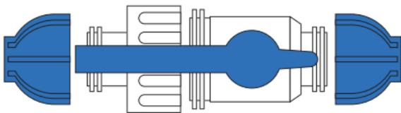
Шаровой кран разъёмной конструкции
